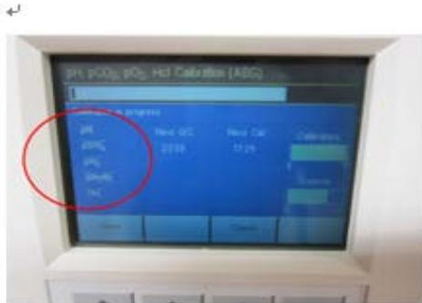
③開始執行全項校正螢幕呈現 PH、PCO<sub>2</sub>、PO<sub>2</sub>、Hct 顯示「X」狀態
