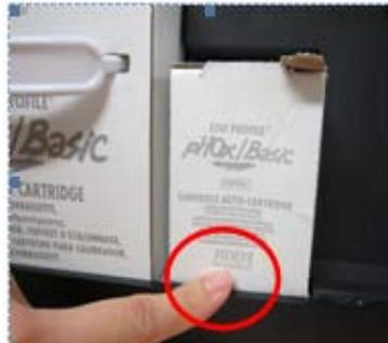
④確認試劑包已推到底，前緣壓進門檻內
