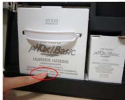
④確認試劑包已推到底，前緣壓進門檻內
