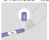
6.3.6. 檢測值顯示於螢幕上,此時<u>儀器會自動抓取該批試片對應的品管液濃度範圍</u>。當品管液檢測值落於合格範圍內時,螢幕會出現"PASS"提示字,當品管液檢測值落於範圍外時(即品管不合格時),螢幕會出現"FAIL"提示文字,當品管結果超出範圍時,血糖機或試片可能發生異常,請勿進行血糖測試,並請檢查上述檢測步驟,排除異常後再重新執行品管液檢測直到高低濃度皆合格為止。
