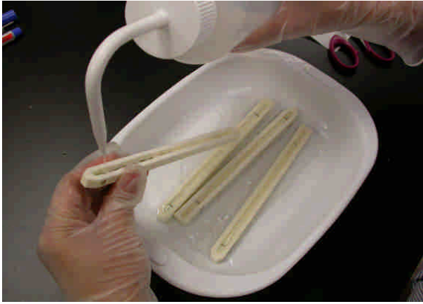
←將跑完 IEF 的 holder 取出,表面先用 ddH 2 O 沖洗
