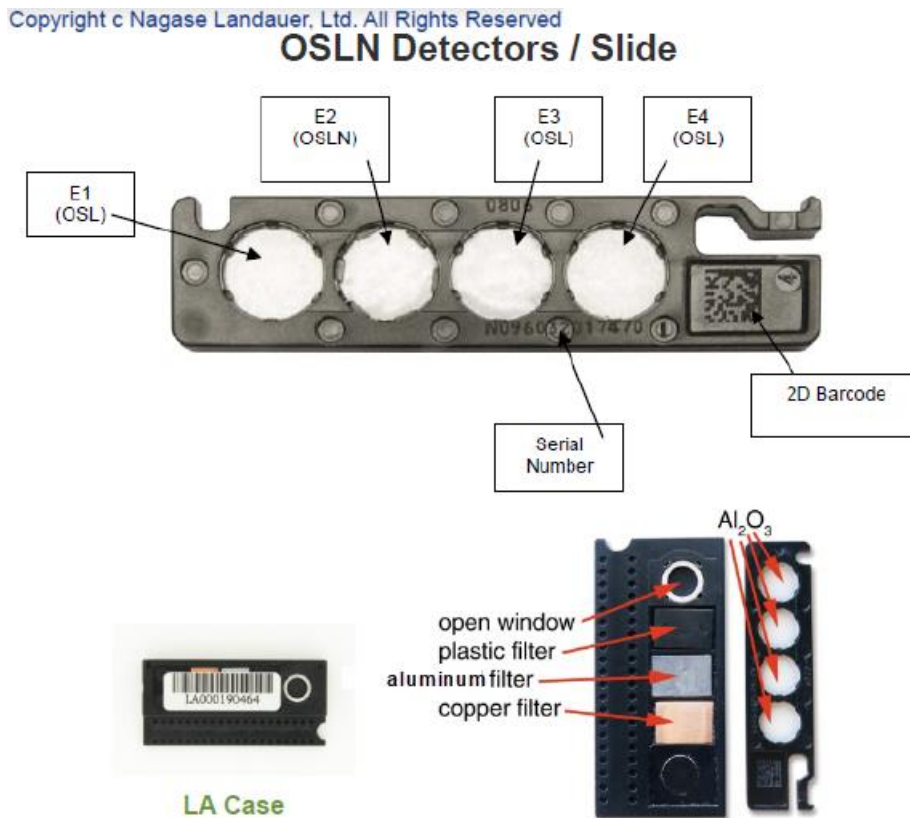
圖一: LA 型光激發光劑量計，外觀及內部構造。E1 位置 open window 的 OSLD、E2 位置為具有 plastic filter 的 OSLND、E3 位置為 aluminum filter 的 OSLD 及 E4 位置為 copper filter，利用 E1、E3、E4 位置的 OSLD 來修正光子對 E2 所造成的劑量修正。
