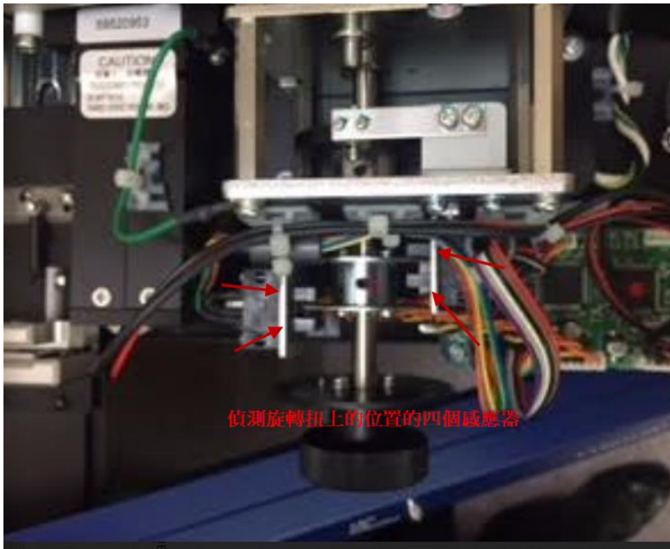
圖八: 光激發光計讀儀內部構造，偵測旋轉鈕上的位置的感應器。
