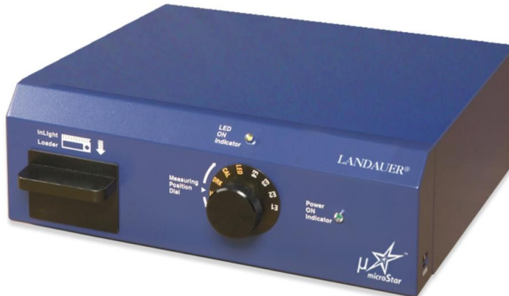
圖一、光激發光計讀儀-microStar reader，轉軸上H/P(Home Position)、DAK、CAL、LED(黃色，標準量測 Standard measurement)、E1、E2、E3、E4(白色，使用在OSLD計讀)。
