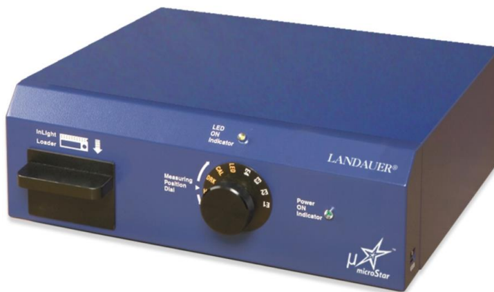
圖一、光激發光計讀儀-microStar reader, 轉軸上H/P(Home Position)、DAK、CAL、LED(黃色, 標準量測 Standard measurement), E1、E2、E3、E4(白色, 使用在OSLD計讀)。
