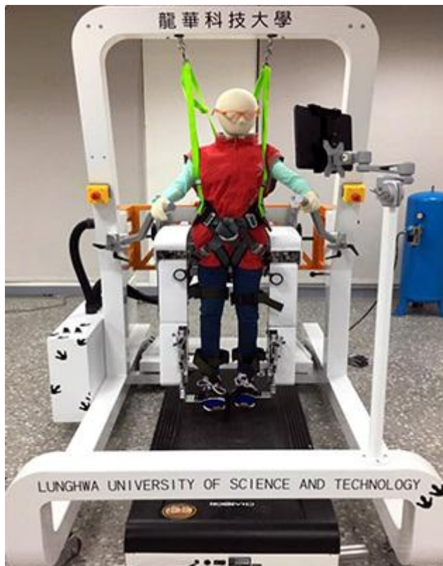
圖為龍華科大獲得新秀獎項肯定的作品-「氣動式下肢步態訓練系統」，已可商品化生產。
