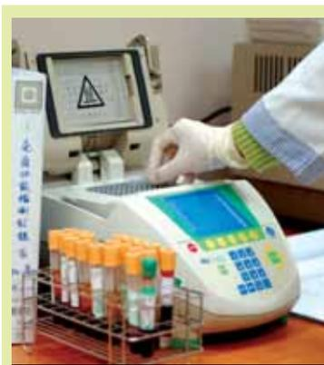
◀ 在人體基因解密後，簡便的 RT-PCR 儀器，可以很快的偵測出造成先天性免疫疾病的相關缺陷基因
